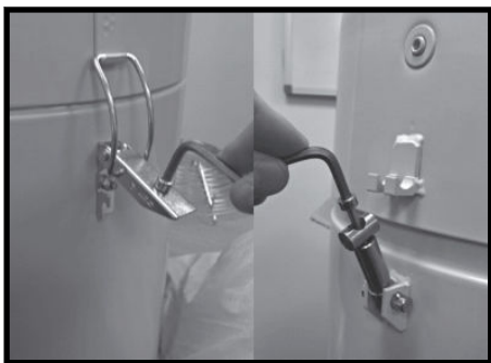
Étape 1 Déverrouillez le loquet de sécurité et les clips.
