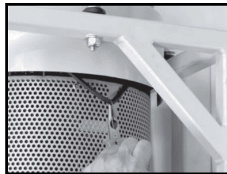
Étape 3 Enlever l'ancien joint.
