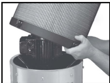
Étape 4 Vérifiez le filtre secondaire (s'il est installé) et remplacez-le si nécessaire.
